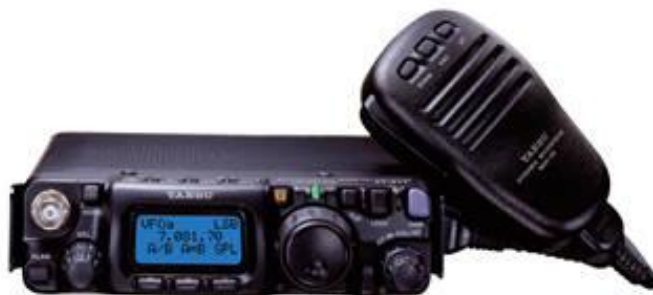
Yaesu FT-817 HF, VHF, UHF portable QRP transceiver, 5W output. Bel voor de prijs
